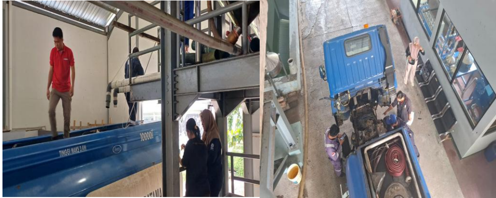
Gambar 13 Pengujian Tera Ulang Tangki Ukur Mobil di workshop kantor UPTD Metrologi Kota Balikpapan
